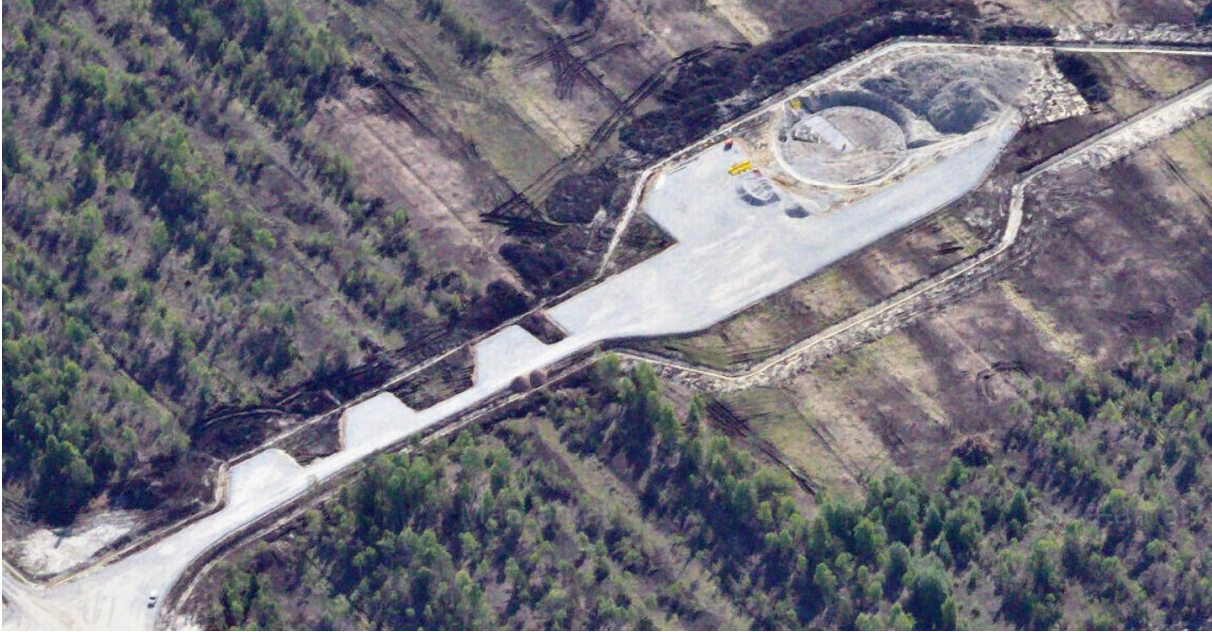
Joonis 4. Võimalik tuuliku vundamendi ala koos montaažiplatsidega. Allikas: Maa-amet Kaldaaerofoto – Tootsi/Sopi tuulepark.
