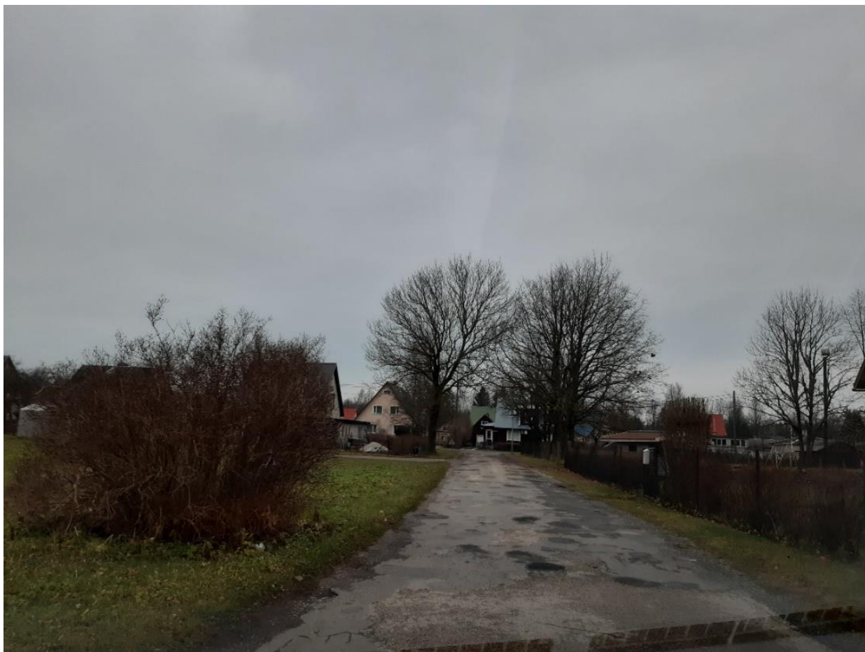
Foto 2. Sellisel tänavalõigul tuleb kaaluda pindamise ja pritskillustiku vahel. On näha, et aukude lappimisest üksi enam ei piisa ja augud taastekivad massiliselt. Defektide kiire areng on osaliselt põhjustatud ka kattel seisvast veest.
